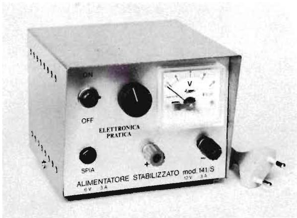
Di facilissima costruzione e di grande utilità nel laboratorio dilettantistico, l'alimentatore stabilizzato e dotato di una moderna protezione elettronica, che permette di tollerare ogni eventuale errore d'impiego del dispositivo, perché la massima corrente d'uscita viene limitata automaticamente in modo da proteggere l'alimentatore da eventuali cortocircuiti.
